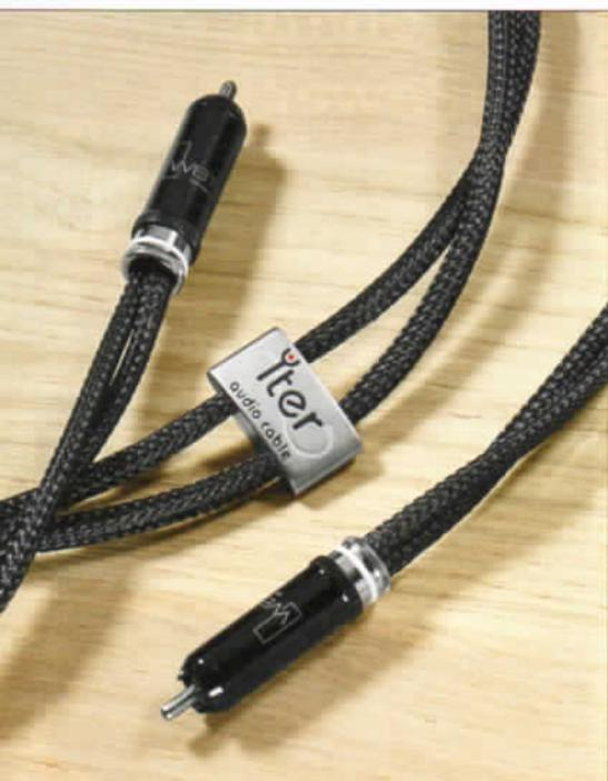
serband per Hand zu extrudieren. Die Yter-Kabel verwenden einen 2,4 mal 0,4 Millimeter durchmessenden, massiven Einzelleiter, dessen bandförmig gewundene, gleichsam verdrehte Topologie induktive Störungen reduzieren und den Skin-Effekt niedrig halten soll. Leiter und Stecker werden dann, um die Materialhomogenität zu wahren, ohne Lötmitel kalt, das heißt unter hohem Druck mechanisch verschweißt. Als Dielektrikum dient ein hochverdichtetes Polymer.
